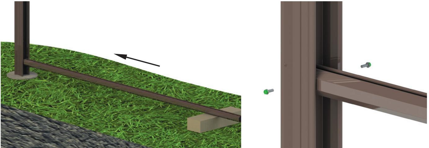
Установите второй столб, контролируя высоту по натянутой веревке. Расстояние между центрами столбов должно равняться 2504 мм. Произведите бетонирование столба. Закрепите в нем направляющую.
